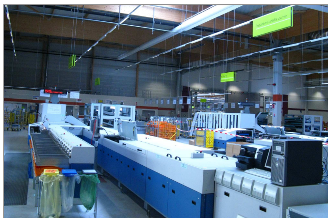
Machine de tri préparatoire du courrier (MTP) : 30 000 plis / heure.
