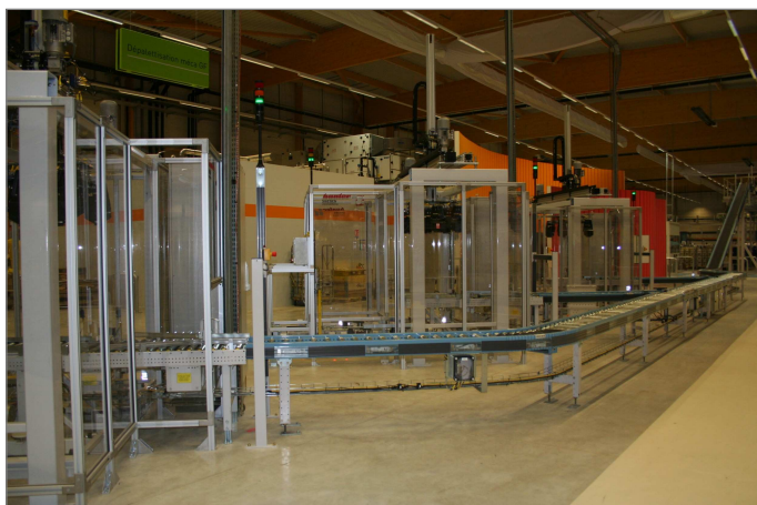
Le dépalettiseur, appareil facilitant la manipulation des caisses courrier.
